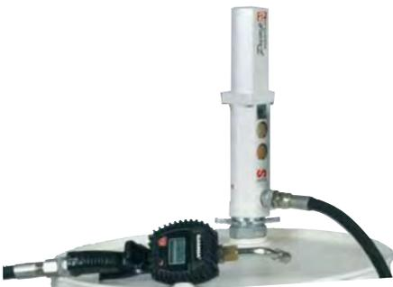
„PumpMaster“ 2 DP-T 3:1 – Druckluft-Abfüllanlagen für Öle
